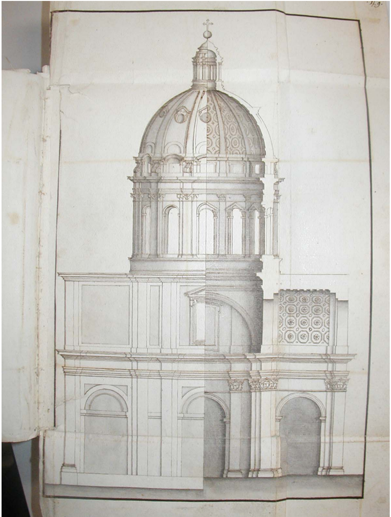
Fig. 12. Anonimo, prospetto-sezione trasversale della chiesa (illustrazione in F.P. Valle, Stato Generale o Libro... cit, 1724, ms. in AGB) L'elaborato consente di ricostruire l'assetto della chiesa prima dei considerevoli restauri del 1856-57. Si notino gli archi che mettevano in comunicazione le braccia trasversali della croce greca con le cappelle, successivamente ridotte a vani-porta.
