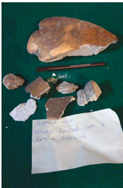
**pezzi di intonaco e di cornice staccatisi dopo il sisma del 2016**
